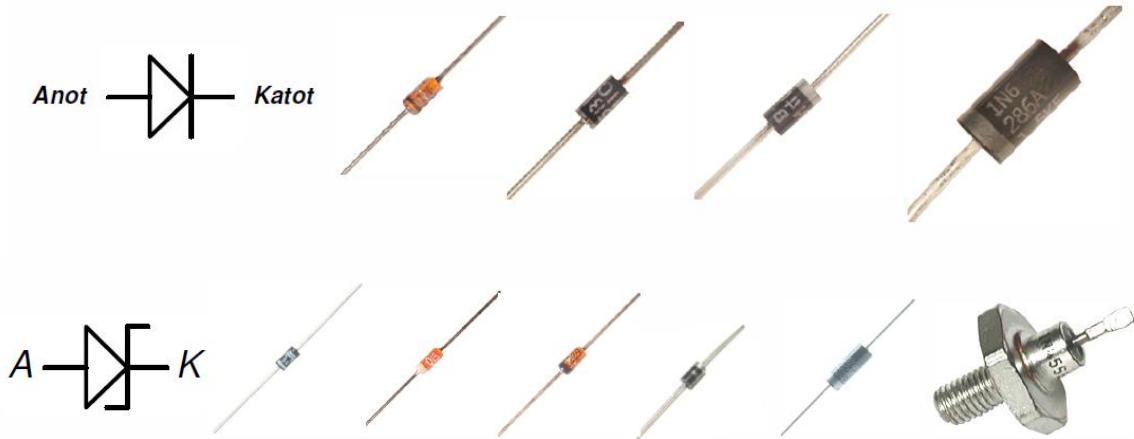
Sekil 4.10. P-N jonksiyon ve Zener diyotun sembolleri ve çeşitli diyot görünüşleri.
