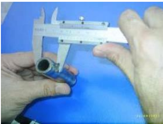
Sürgülü kumpas ile DIŞ boyut ölçme
