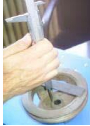
Sürgülü kumpas ile DERİNLİK ölçme(Indirect)
