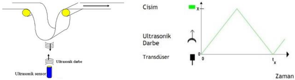
Şekil 2.1. Ultrasonik sensörün çalışma mantığı
