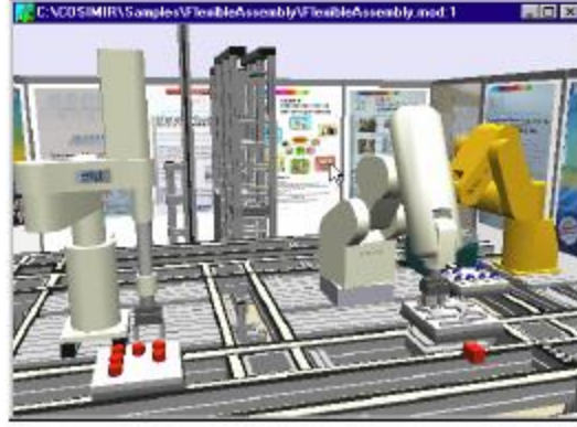
Şekil 3. COSIMIR programı iş hücresi(workcell) ekranı.
